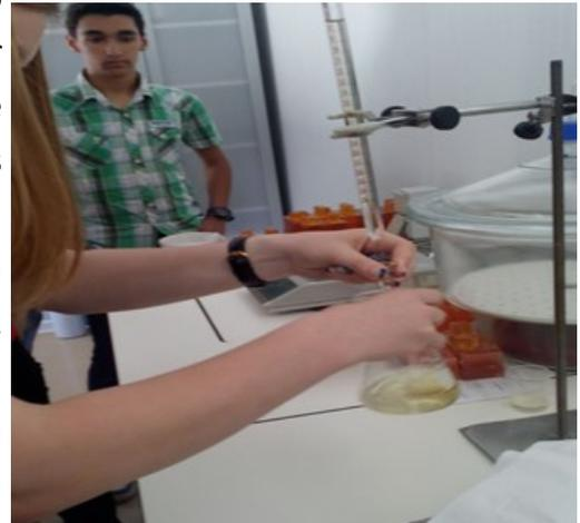
O calorímetro produzido pelos alunos revelou propriedades isolantes como pudemos confirmar com os ensaios realizados (arrefecimento de água num gobelé, com e sem calorímetro). Os resultados obtidos sugerem que o calorímetro tem de fato, capacidade de isolamento térmico, uma vez que constatámos em vários ensaios, um fluxo térmico menos acentuado da água aquecida para a vizinhança, no caso do calorímetro.
